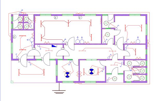
05 SWITCH SOCKET RING 3X2.5MM2 08 AIR CONDITION 06 AIR CONDITION 02 LIGHTS 8pts 03 LIGHTS 7pts 04 LIGHTS 9pts 01 LIGHTS 9pts 8WAY TPN DISTRIBUTION BOARD MORTUARY 07 FAN 3X1.5MM2 3X2.5MM2 3X1.5MM2 3X2.5MM2 3X2.5MM2 3X2.5MM2 3X2.5MM2 C20A O15A C10A O10A C10A C10A C20A 100A 300mA ELCB
